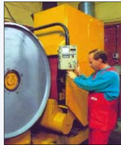
Рис. 2. Общий вид установки для динамической балансировки пильных шкивов диаметром 1500 мм
